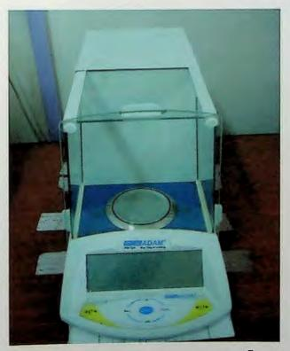
Plate 7 : An Electronic Balance (ADAM <sup>R</sup> PW-124)
